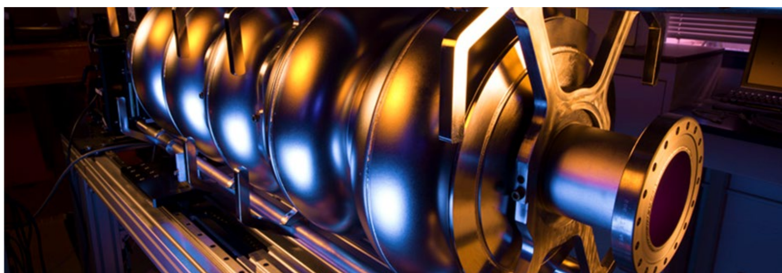
Un ensemble de cavités radio-fréquences qui créent un champ électrique alternatif dirigé suivant l'axe de la structure.
