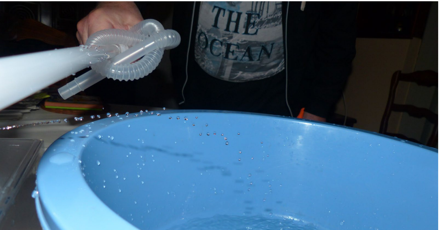
L'approche du tuyau de plastique frotté dévie le jet d'eau vers le haut.
